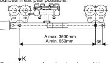
Entretoise avec pièce de raccordement des deux côtés, sur KBK III utilisation non possible pour déplacement dans les courbes
