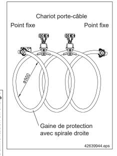
Pour les appareils de levage à commande pneumatique, des systèmes d'alimentation en énergie spéciaux sont nécessaires. Dans certains cas on a besoin d'énergie pneumatique et d'énergie électrique sur le chariot.
