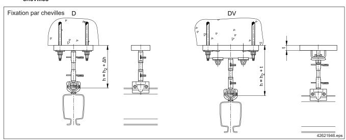
Les installations KBK peuvent être fixées au moyen de chevilles sur une superstructure en béton. Utiliser pour ce faire des chevilles homologuées pour charges dynamiques. Les travaux de montage doivent être effectués par un personnel formé et sont à inscrire dans un procès-verbal.
