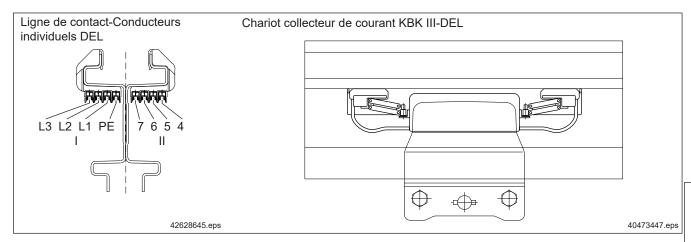
On peut intégrer huit rails conducteurs au profilé KBK III ; pour les tronçons sans embranchement, on peut prévoir plus de huit rails. Degré de protection IP 23 ; DEL 25/50 mm², 100/200 A. La section de raccordement maxi pour la ligne d'alimentation DEL est de 10 mm².
