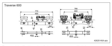
Traverse 600 utilisable sur installations de pont et monorails droits comme traverse de chariot et traverse-sommier pont monopoutre. En cas d'utilisation du chariot collecteur de courant, celui-ci peut être placé entre les chariots.
