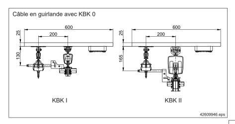
Par le montage latéral d'un câble en guirlande sur le rail KBK, on peut diminuer la cote d'approche et augmenter la longueur du poste d'accumulation au-delà de l'extrémité du rail.
