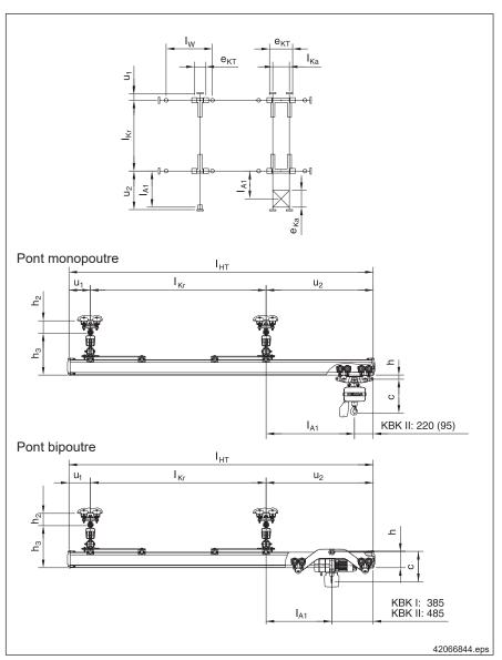
Les poutres de pont peuvent avoir aux deux extrémités un porte-à-faux  $u_2$  si on augmente proportionnellement la longueur de pont  $I_{\text{HT}}$  tout en maintenant la portée  $I_{\text{Kr}}$ .
