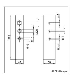
On peut avec un gabarit de perçage facilement percer un alésage sur les tiges filetées après raccourcissement par les soins du client. Observer l'écart avec l'extrémité.
