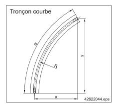
La construction des tronçons de voie courbes est identique à celle des tronçons de voie droits. Sur les installations KBK II-L et KBK II-H, on utilise des tronçons courbes KBK II.
