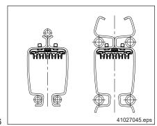
Les profilés KBK II-R et KBK II-H-R sont munis de cinq conducteurs incorporés. Les points d'alimentation électrique se trouvent en extrémité de voie ou sur les tronçons d'alimentation. Si un monorail comprend des aiguillages ou des plaques tournantes en exécution R, l'alimentation s'effectue à partir de ces ensembles, également pour les voies de dérivation. Le chariot collecteur de courant correspondant est équipé de quatre ou cinq paires de frotteurs doubles montés sur ressorts.
