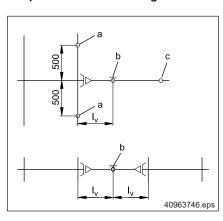
Sur le côté verrouillage, prévoir pour la voie de pont, à 500 mm du milieu de la voie de dérivation, côté droit et côté gauche, une suspension de voie (a). Prévoir d'autres suspensions en respectant l'écartement des suspensions prescrit. La longueur de la tige filetée doit être d'au moins 100 mm.
