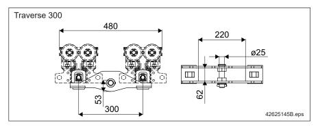
Traverse 300 pour réaliser un chariot double, comme traverse de chariot ou de pont monopoutre.
