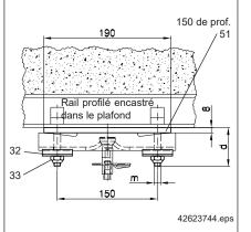
Ou autre vis spécifiée pour rail profilé encastré dans le plafond avec ferrure de plafond H.
