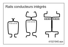
Pour KBK 100, I, II-L, II, II-H, des câbles plats d'alimentation électrique suspendus à des patins ou à des chariots porte-câble se déplaçant dans le même profilé ; utilisation pour KBK III de KBK 25.
