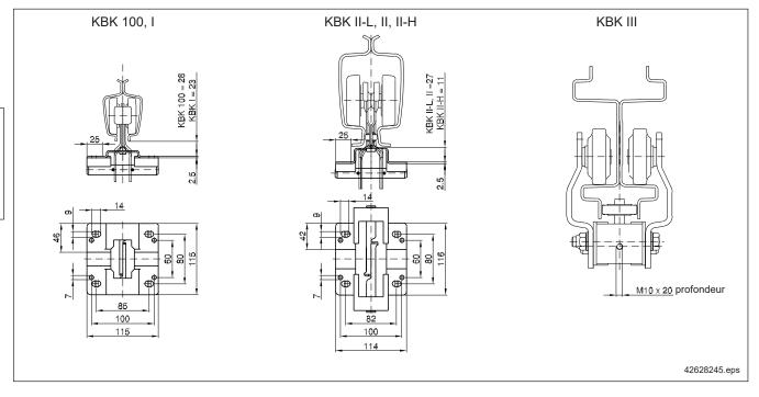
Kit complet avec tôle, axe, rondelles et douilles extensibles
